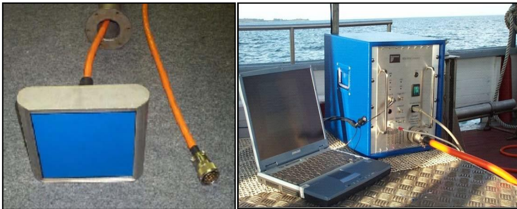
Figura 6. Sondador paramétrico INNOMAR SES-2000 COMPACT; transductor y centralita electrónica del sondador.
